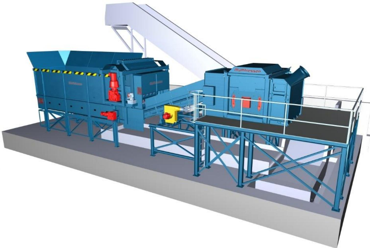
Разрыватель пакетов (слева) и Сепаратор пленки (справа)
